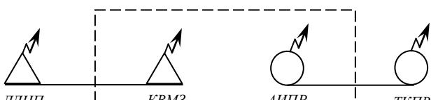
**Рис. 5.** Передача через промежуточную радиостанцию ЛДНП — позывной радиостанции, предлагающей радиограмму; КВМЗ, АИПР — позывные промежуточной радиостанции; ТКПВ — позывной станции, которой адресована радиограмма.
