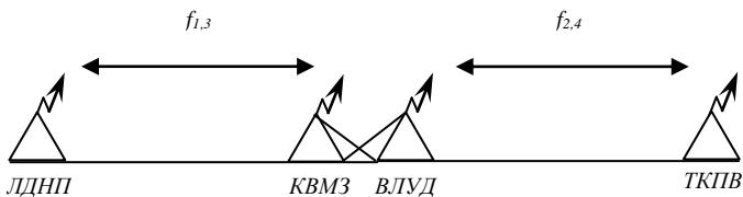
**Рис. 8.** Радиообмен через радиоретрансляционные узлы (пункты):
